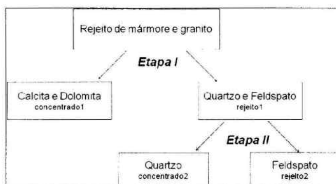
Figura 1. Esquema dos ensaios de flotação.
