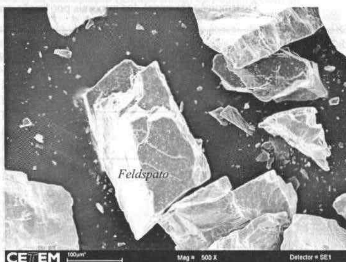
Figura 2. Micrografia obtida por microscopia eletrônica de varredura (MEV/SE) do concentrado de feldspato.
