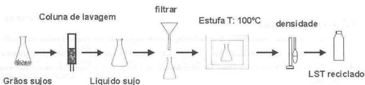
Figura 02. Desenho esquemático da reciclagem do líquido denso LST.
