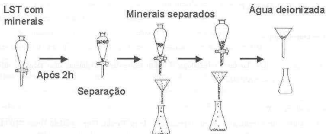
Figura 01. Desenho esquemático da separação por meio denso.
