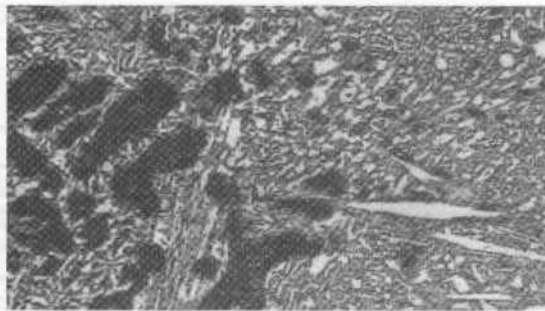
Figura 3 – Micrografia típica de amostras fabricadas em ferro fundido alto cromo
